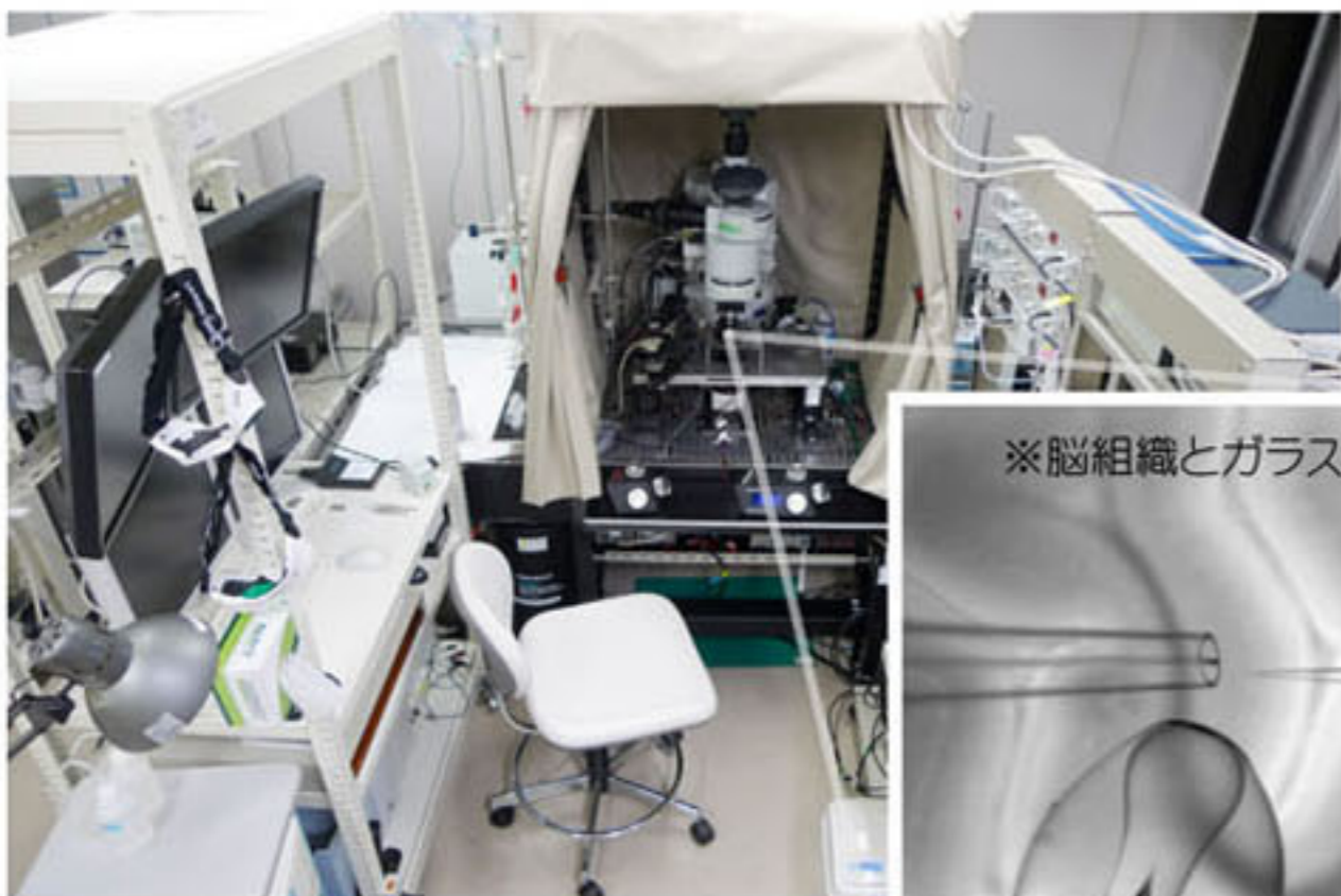
※ 生きたままの脳組織標本で細胞活動を光で操作する装置。
